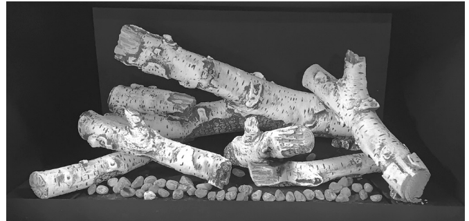
Illustration 7.41. Placez les pierres de brasse du brûleur (incluses dans le kit divers) en une couche uniforme sur le brûleur en acier. Veillez à ne pas obstruer la zone de la veilleuse ou les orifices de transfert du brûleur.
