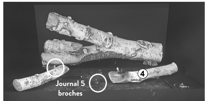
Illustration 7.38. Engagez les trous dans le dessous de la bûche droite #4 avec les 2 goupilles de brûleur correspondantes indiquées sur la fig. 7.37.
