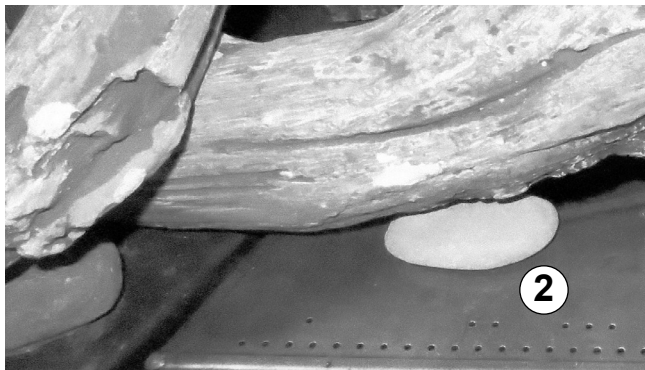
Figure 7.29. Placez le rondin du brûleur gauche n° 2 sous le côté gauche de la bûche quatre, devant l'ouverture la plus à gauche du brûleur avec le numéro intégré orienté vers l'intérieur.
